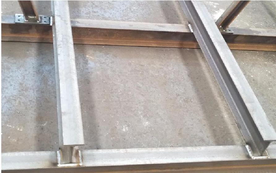
Figura 38 Saldature tipo, realizzate in stabilimento
